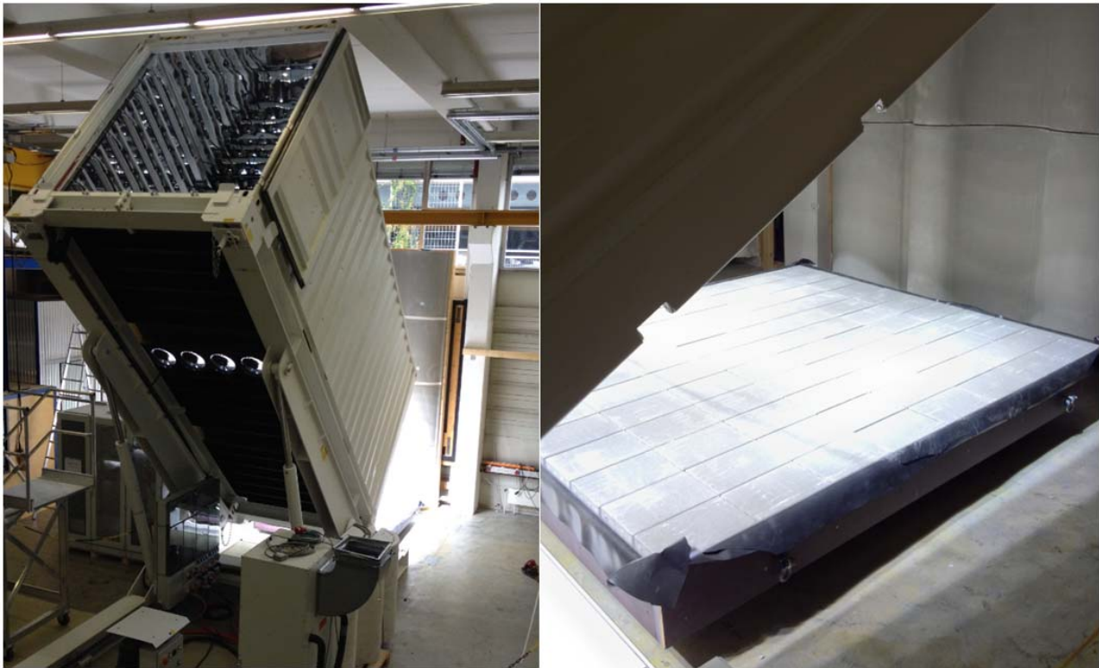
Bild 8: Versuchseinrichtung für praxisnahe Erwärmungs- und Verdunstungsprüfung von Verkehrsflächen bei variablen sommerlichen Randbedingungen (dargestellt sind 60°) [14].
