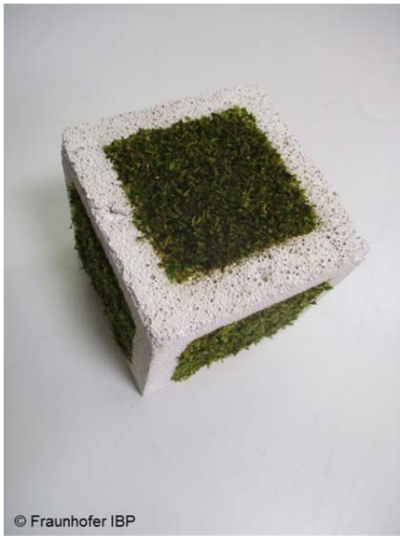
Bild 4: Dreidimensionale Prüfkörper mineralischer Baustoffe, begrünt mit Moos.
